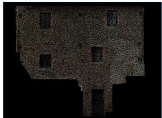
fig. 40 - CF 4, modello tridimensionale del prospetto meridionale definito tramite Z-Map .
