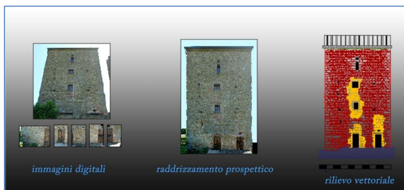
fig. 34 - Schematizzazione del processo di rilievo fotogrammetrico attraverso il metodo del raddrizzamento prospettico.
