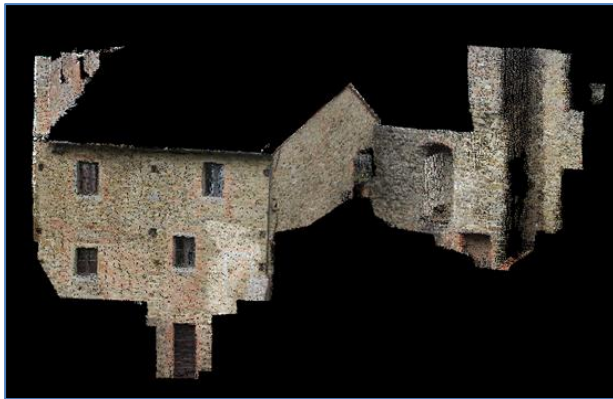
fig. 39 - CF 4, modello tridimensionale generato tramite U-Map .
