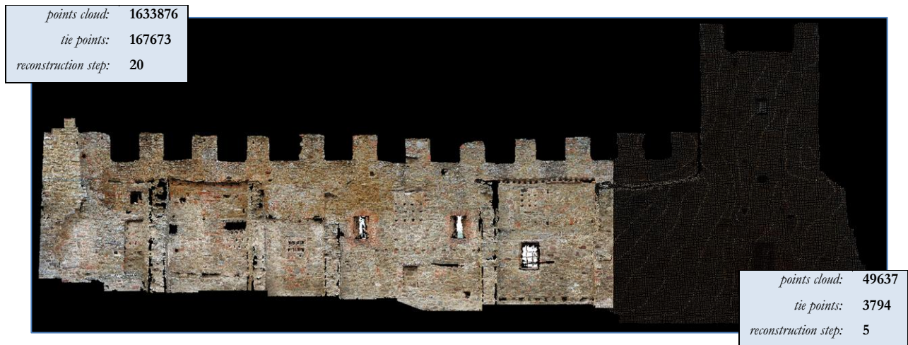
fig. 61 - CFW, modello tridimensionale del prospetto murario definito tramite Z-Map.
